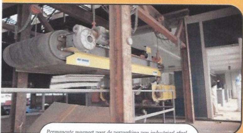
Permanente magneet voor de verwerking van industrieel afval aan het einde van een sorteerlijn. Opstelling in lijn bovenband.
